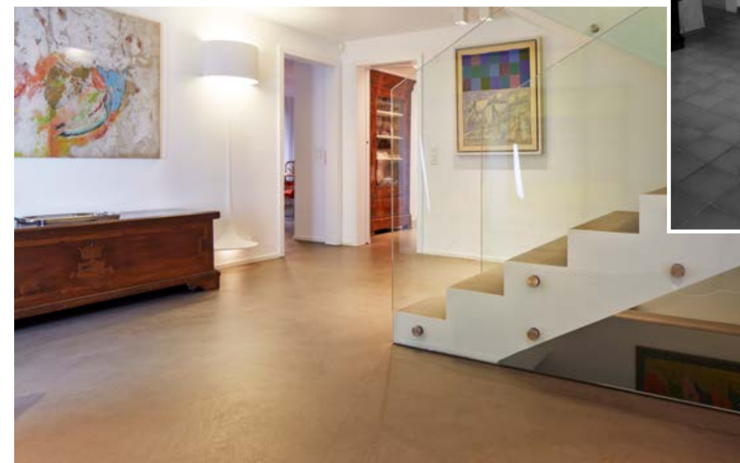
Auch die Eingangshalle, inklusive der neuen Treppe, strahlt heute eine moderne, schlichte Eleganz aus. Bodarto wurde hier direkt auf die alten Bodenplatten verlegt.
